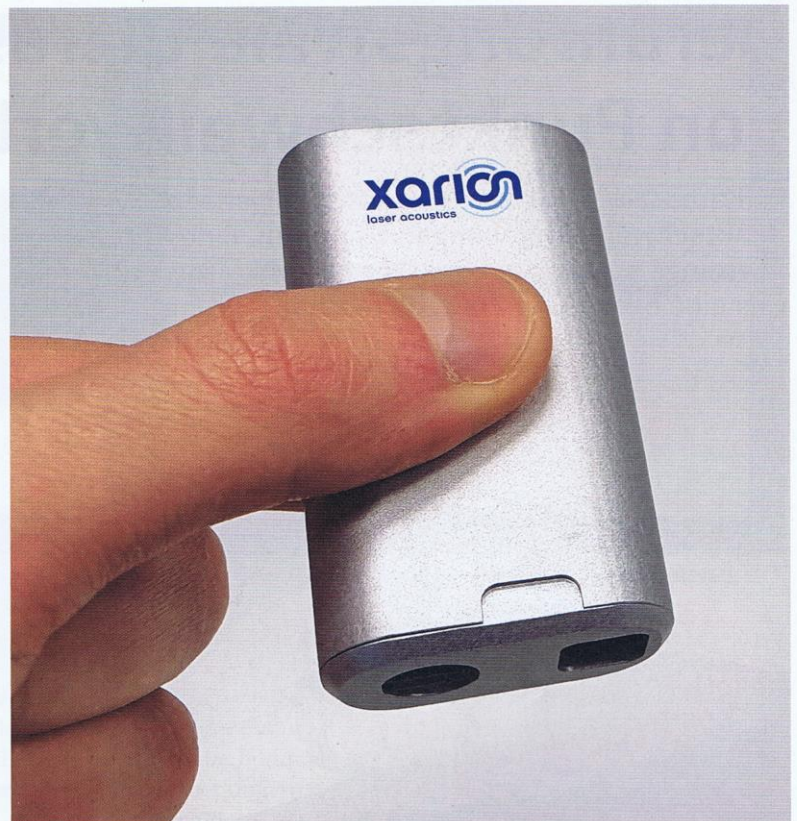
Bild 3: Der kompakte Prüfkopf für die berührungslose, einseitige Prüfung von Punktschweißverbindungen. In ihn werden der Anregungslaser und das optische Mikrofon integriert.
