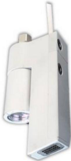
**Abb. 6: Der kompakte Prüfkopf** für die berührungslose einseitige Ultraschall-Prüfung von Werkstücken und Schweißverbindungen. In ihm werden Anregungslaser und Optisches Mikroskop vereint. Kein Gel oder Wasser ist nötig.
