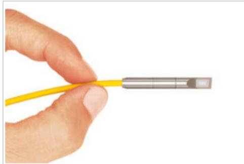
In enger Kooperation mit der Porsche Leipzig GmbH hat die Firma Xarion Laser Acoustics aus Wien nun ein Prüfverfahren auf Basis des optischen Mikrofons entwickelt. Dieses ermöglicht eine berührungsfreie Ultraschallprüfung von Punktschweißverbindungen mittels eines Lasers. Das optische Mikrofon wurde dazu gemeinsam mit einem ultraschallerzeugenden Laser in einen kompakten Prüfkopf integriert.
