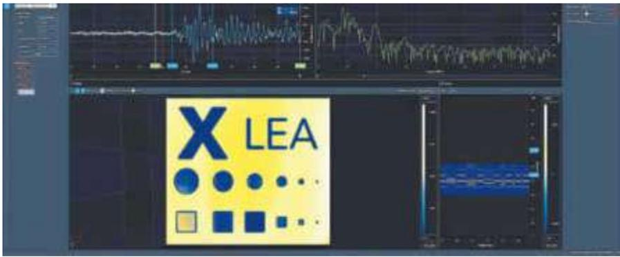
Die LEA-Studio-Software von Xarion wurde mit Blick auf eine dreidimensionale Welt entwickelt. Ein 3D-C-Scan-Bild ermöglicht die unkomplizierte Identifikation von Fehlstellen auf beliebig geformten Bauteilen.
