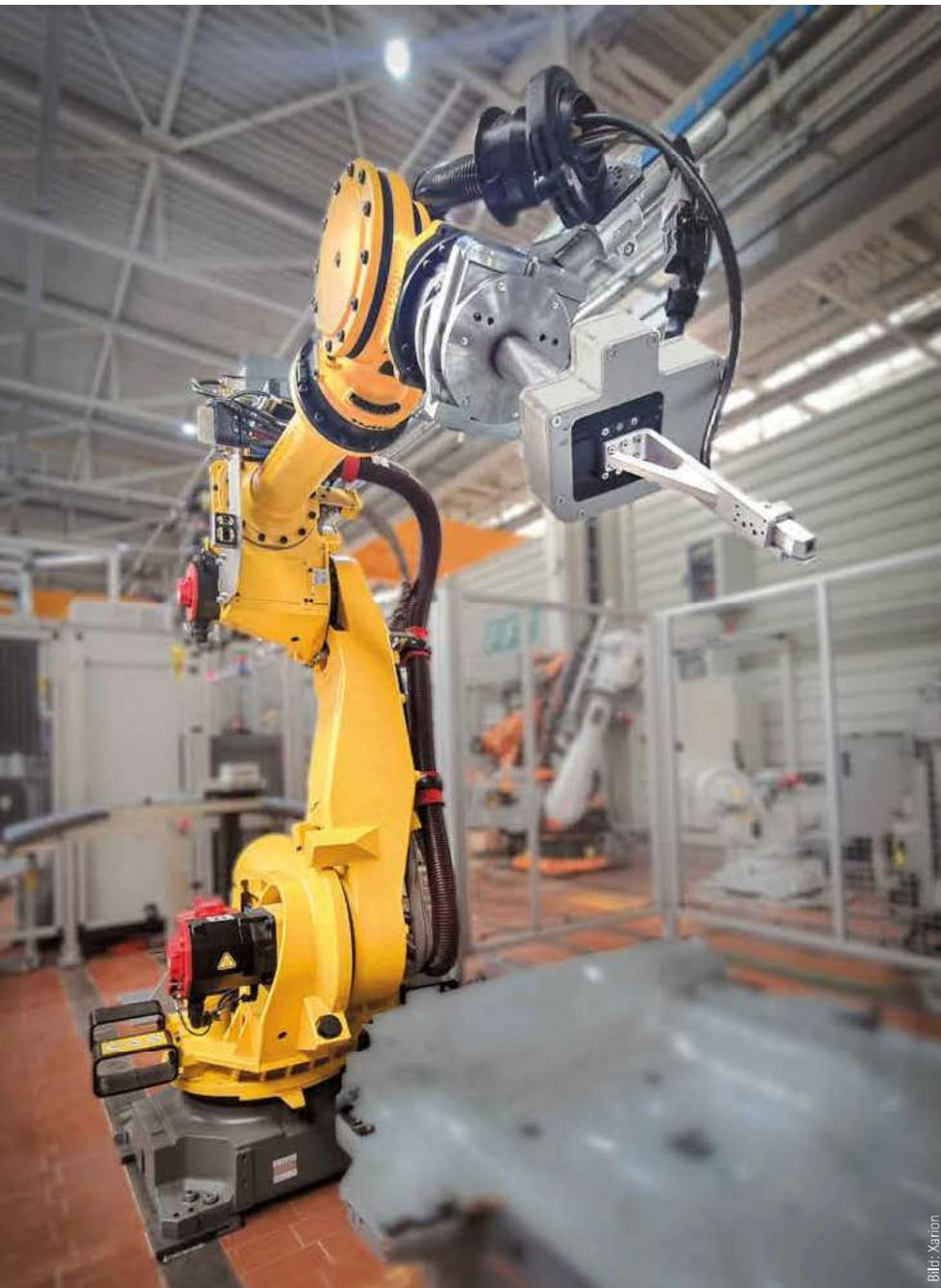
**M**it dem Inspektionssystem der Wiener wird ein Ultraschallbild vollständig berührungslos und automatisiert erfasst. Dadurch lassen sich selbst winzige Defekte schnell und präzise identifizieren – von Delaminationen und Rissen über minimale Fehlstellen bis hin zu feinen Schweißfehlern. Das Ergebnis ist eine zuverlässige Qualitätssicherung, die nicht nur für mehr Sicherheit sorgt, sondern auch nachhaltig das Vertrauen von Kundinnen und Kunden stärkt.
