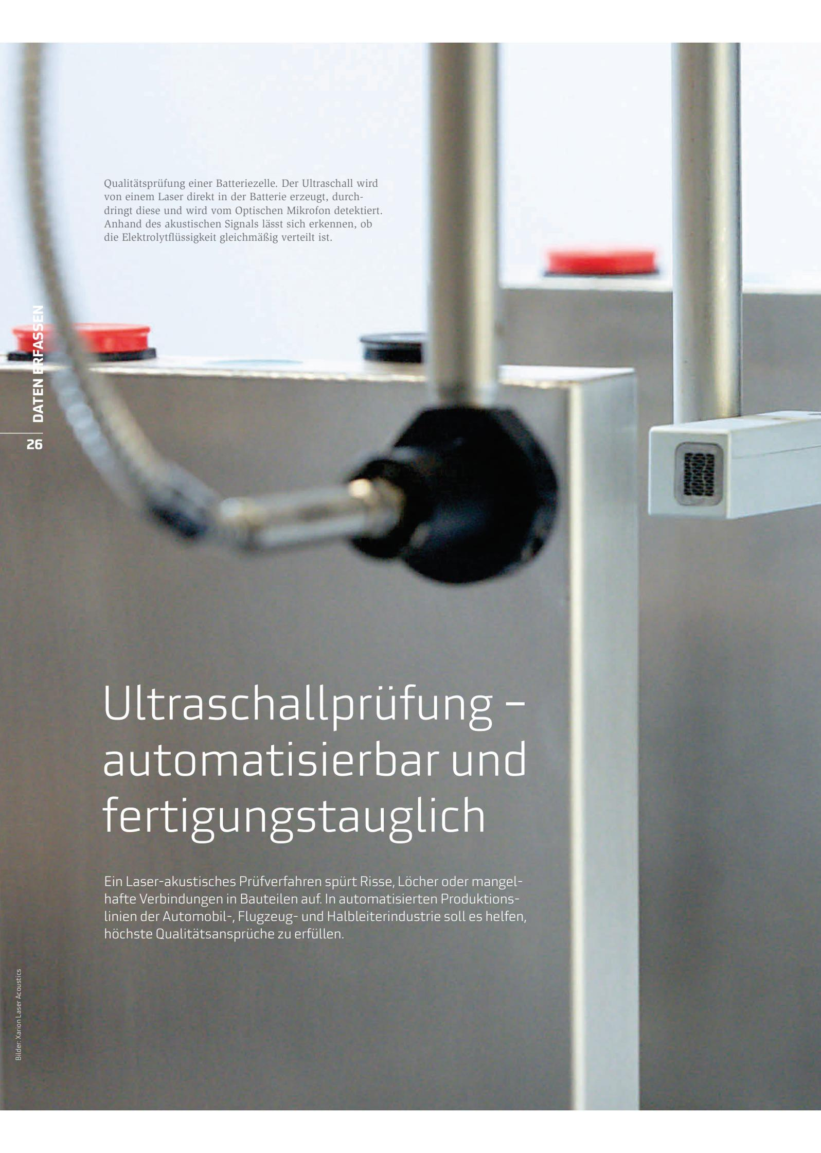
Qualitätsprüfung einer Batteriezelle. Der Ultraschall wird von einem Laser direkt in der Batterie erzeugt, durchdringt diese und wird vom Optischen Mikrofon detektiert. Anhand des akustischen Signals lässt sich erkennen, ob die Elektrolytflüssigkeit gleichmäßig verteilt ist.
