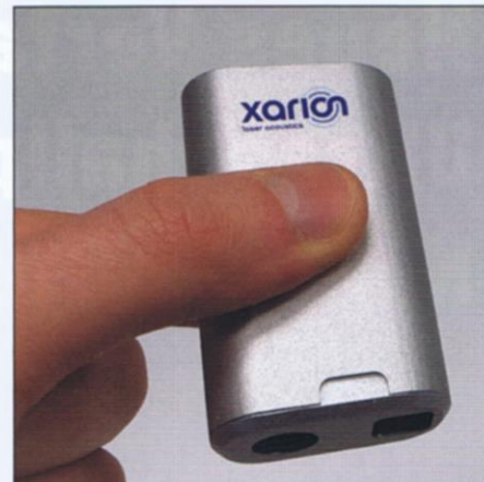
Kompakter Prüfkopf für die berührungslose einseitige Prüfung von Punktschweißverbindungen.
