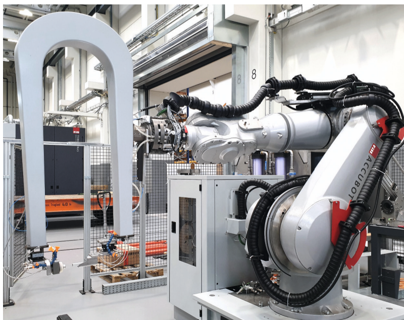
Prüfroboter für Kohlefaserverbundstoffe: Dieses Prüfsystem kommt in der Luft- und Raumfahrt zum Einsatz. Die Ultraschallprüfung ohne den Einsatz von Ultraschallgel oder Wasser bietet den Kunden einen großen Mehrwert, da das Bauteil nicht direkt berührt werden muss. Dieses Bild zeigt einen Aufbau in Durchschallung, auch einseitige Puls-Echo-Anordnungen sind möglich.
