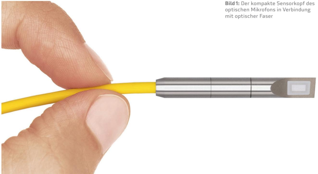
**Bild 1:** Der kompakte Sensorkopf des optischen Mikrofons in Verbindung mit optischer Faser
