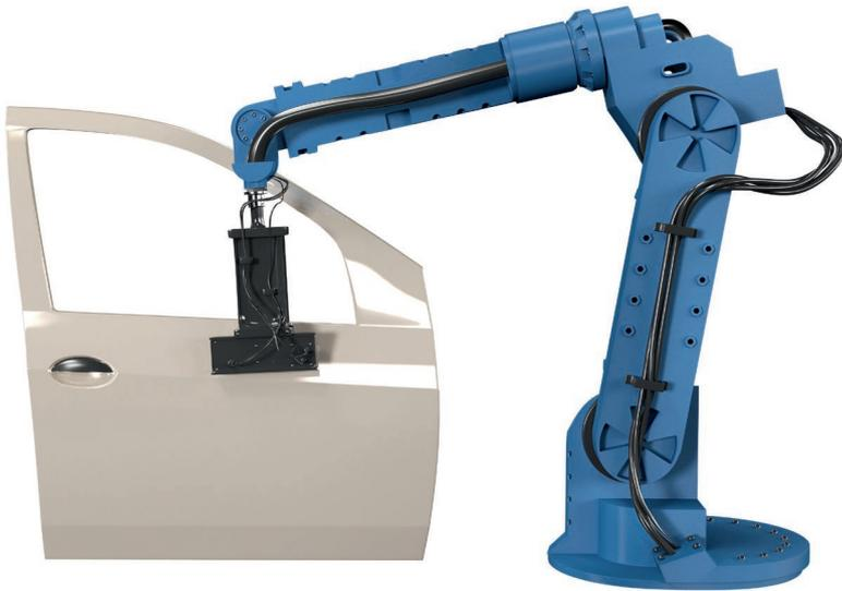
**Bild 3:** Optisches Mikrofon montiert auf einem Roboterarm zur Qualitätssicherung in der Automobilindustrie
