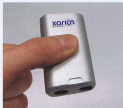
In den kompakten Prüfkopf für die berührungslose einseitige Prüfung von Punktschweißverbindungen werden der Anregungs-Laser und das optische Mikroskop integriert.
