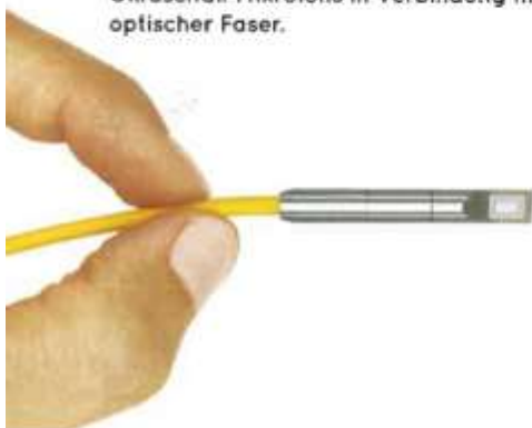
Der kompakte Sensorkopf des optischen Ultraschall-Mikrofons in Verbindung mit optischer Faser.
