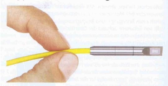
Ein neues Verfahren zur Ultraschallprüfung von Punktschweißverbindungen von Xarion Laser Acoustics, basierend auf dem optischen Mikrofon, macht den Einsatz von Koppelmittel überflüssig. Das optische Mikrofon wurde dazu gemeinsam mit einem ultraschallerzeugenden Laser in einen kompakten Prüfkopf integriert und lässt sich auf diese Weise auf einen Roboter montieren. Der glasfasergekoppelte Sensorkopf ist nur wenige Millimeter groß und erreicht dadurch auch schwer zugängliche Stellen.
