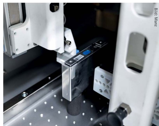
Das Innenleben der Batteriezellenprüfanlage von Xarion und Manz: Hier werden auf der einen Seite der Zelle mit einem Laser Ultraschallsignale erzeugt und auf der anderen Seite mit Xarions Mikroskop analysiert. Dabei ist kein Wasser oder Gel nötig.
